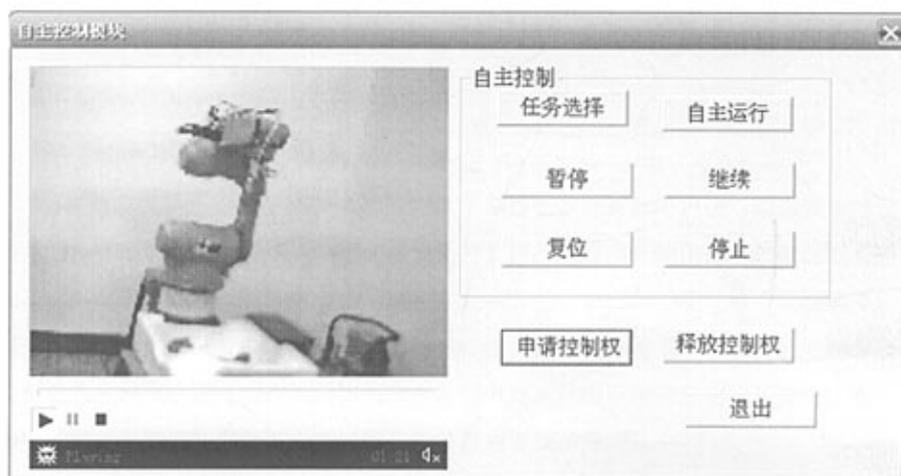
图 4.8 Client 端用户自主任务控制模块界面
