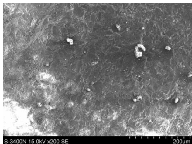
图5-2 混凝土表面原始SEM形貌
