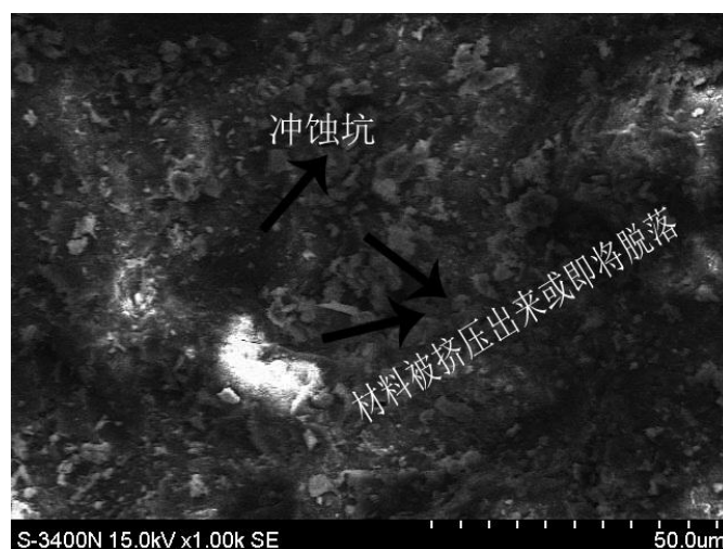
图5-5混凝土冲蚀磨损表面的SEM形貌图 (At 90°)
