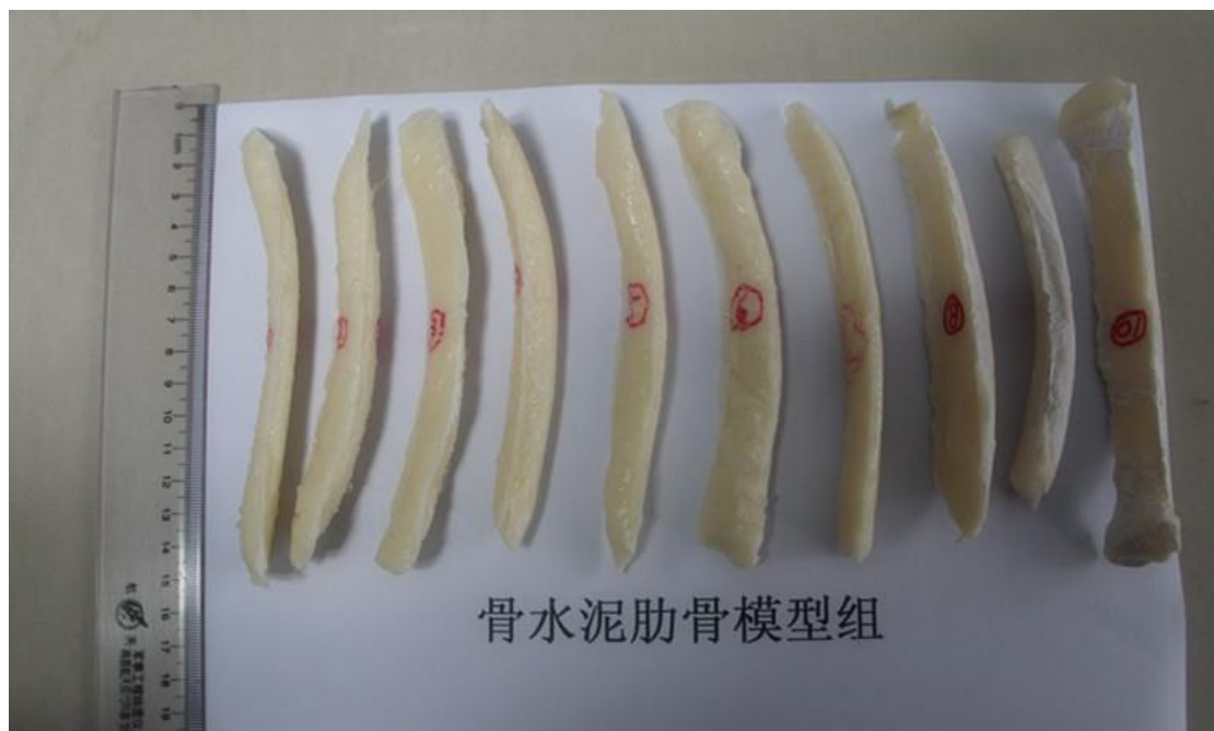
图 2-2 使用模具制备完成的单纯骨水泥材料肋骨骨组织模型
