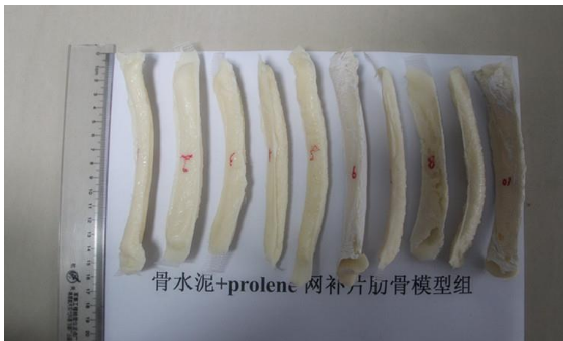
图 2-3 使用模具制备完成的 prolene 网补片与骨水泥复合材料肋骨骨组织模型
