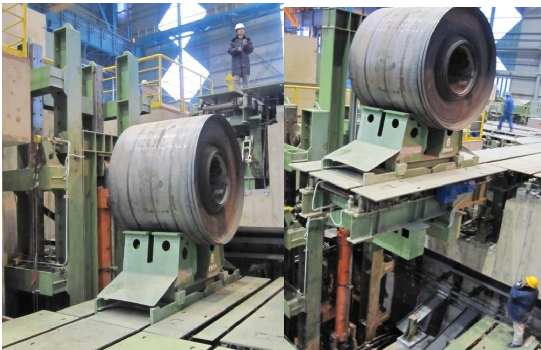
图 5-3 重载提升装置生产运行图
