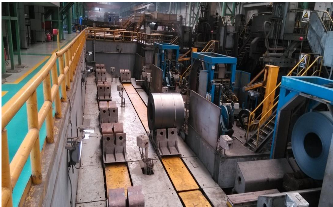
图 5-1 双排式托盘运输系统生产运行图（一）
