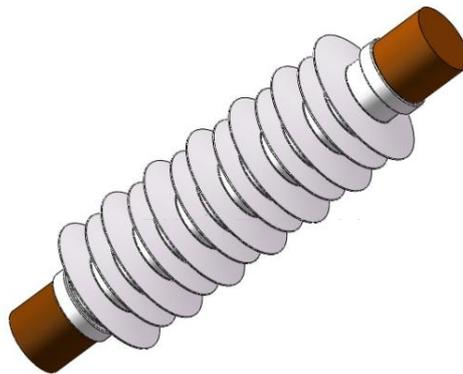
图 3.3 绝缘子三维简化图
