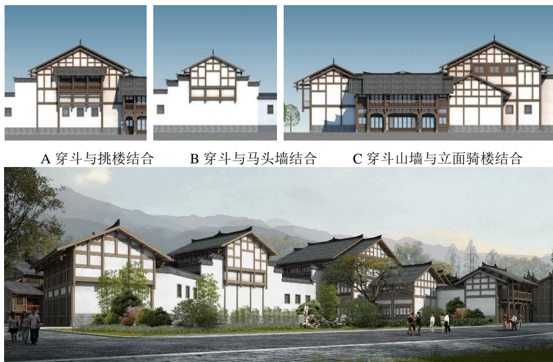
图 0.37 天后宫侧院建筑山墙穿斗构架
