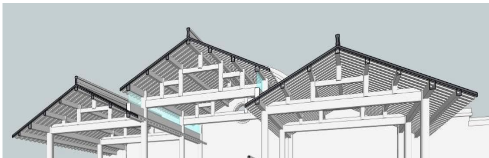
图 0.4 天后宫后殿屋架结构
