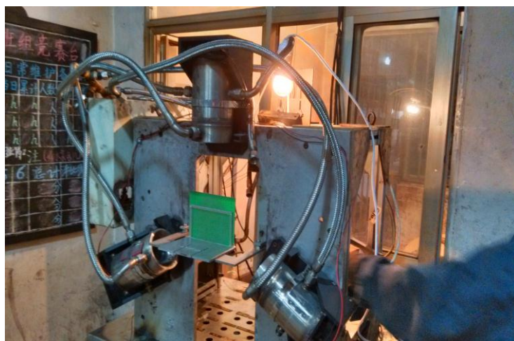
图 2-13 系统框架实物图及摄像机标定过程
