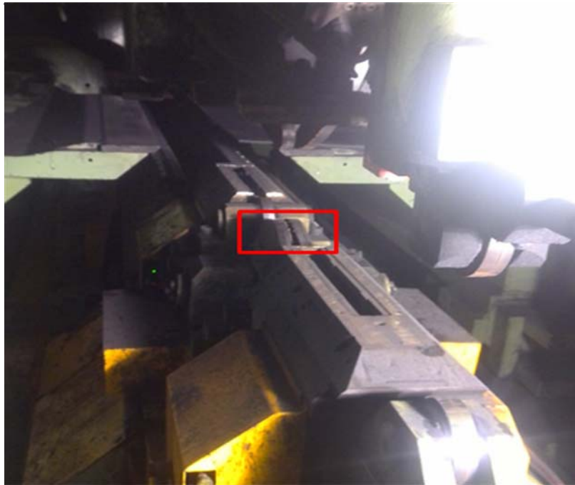
图 5-13 调整下工作头焊轮高度
