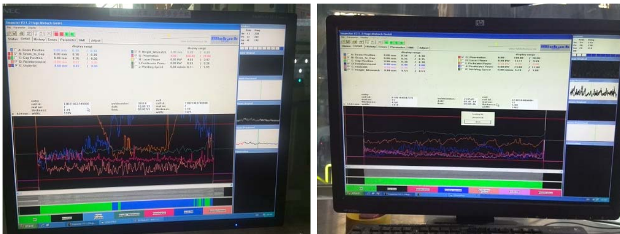
图 5-17 有无二次剪切的焊接曲线比对差异明显
