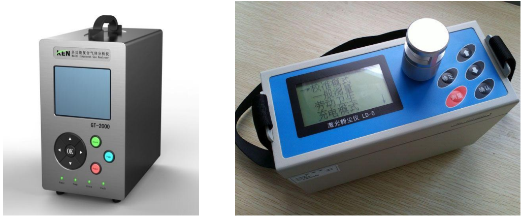
图 4.3 GT-2000 多功能复合气体分析仪和 LD-5C 激光粉尘仪
