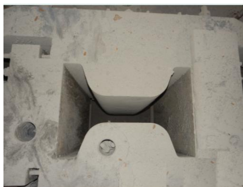
图 2.1 长钢 H 型结晶器现场图
