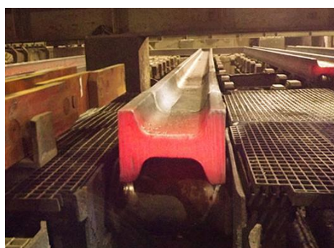
图 1.3 长钢 H 型连铸坯实拍图
