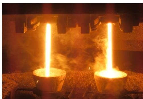
图 1.2 直通型双水口半敞开式浇铸
