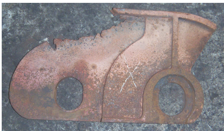
图 2.8 局部氧化烧损失效的侧板
