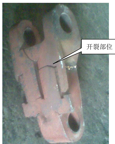
图 2.7 断裂失效的链节
