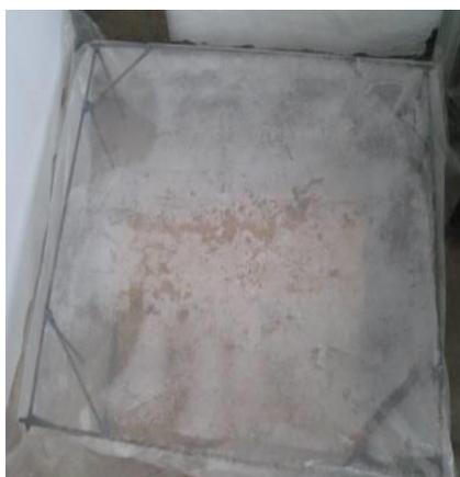
图 4-5 冻融试验中土样模型
