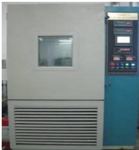
图 3-5 三温冻融循环试验仪
