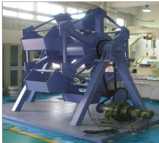
图3-2 观览车模拟试验装置实物图
