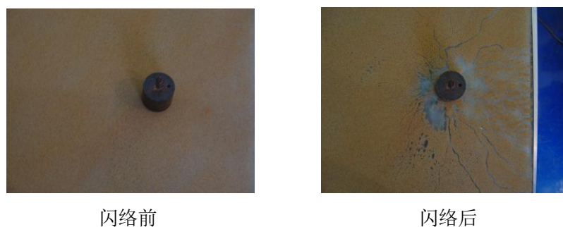
图 5.11 沙粒沉积密度为 0.025\text{g}/\text{cm}^2 时平板模型闪络前后对比图
