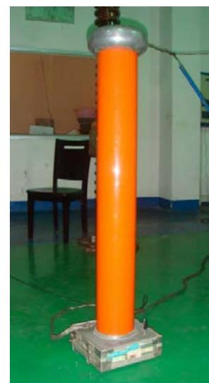
图 2.7 SGB - 200A 分压器
