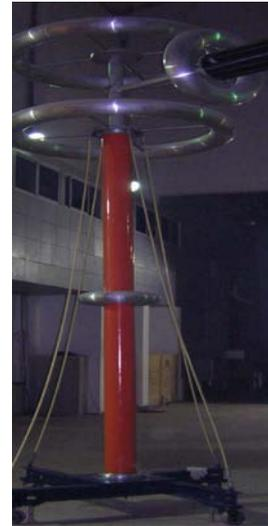
图 2.10 500kV 交流电容式分压器
