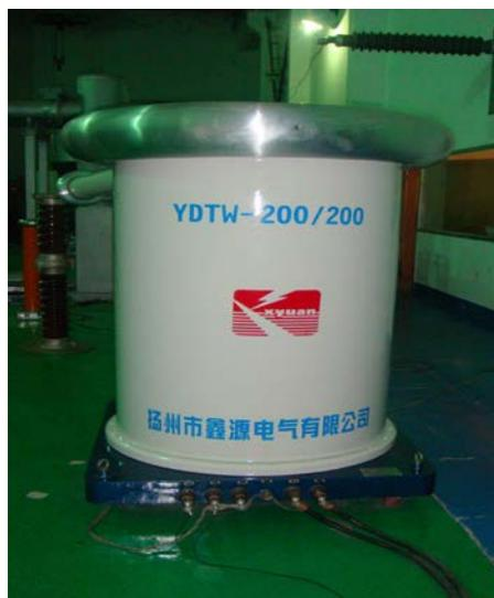
图 2.6 200kV/200kVA 交流试验变压器
