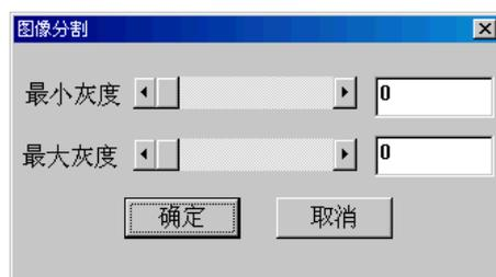
用鼠标拖动滑块, 可以将图像中要测量的部分提取出来。只有把目标提取出来, 才能对目标进行面积等参数的测量。这种方法是根据图像的灰度值提取目标的。即把在最小灰度和最大灰度这间的图像视为要测量的目标, 并用红色表示。
