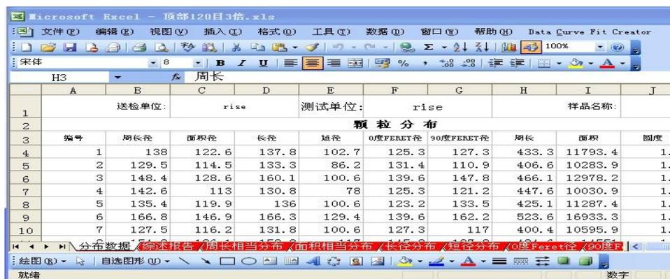
第七步：图像处理好之后，点击测量，这时如果在测量设置中选中标号后，会在图像上对测量目标标号。在显示结果中单击某个编号，可以在图像上对这个目标追踪显示。如果操作系统中装有 Excel，单击分析报告，会将分析数据传到 EXCEL 中如下图所示，单击检测报告，在弹出的对话框中输入报告信息，会形成一个检测报告传到 EXCEL，如果要看统计图，可以在下拉框中选择要统计的参数，单击统计图就可以了。
