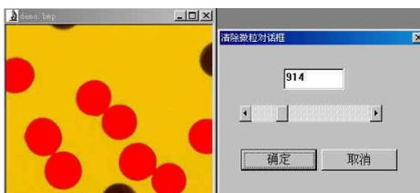
滑动滑块，改变清除微粒的面积，面积小于显示的像素个数的目标将在图像测量时不被计算在内。（图中黑色部分为被清除的微粒）。
