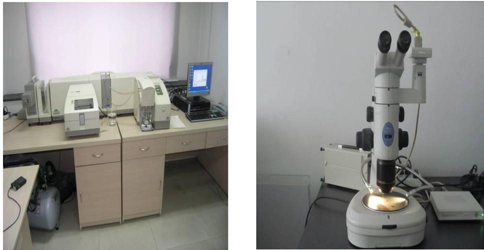
图 2.2 激光粒度仪（左图）和尼康显微镜（右图）
