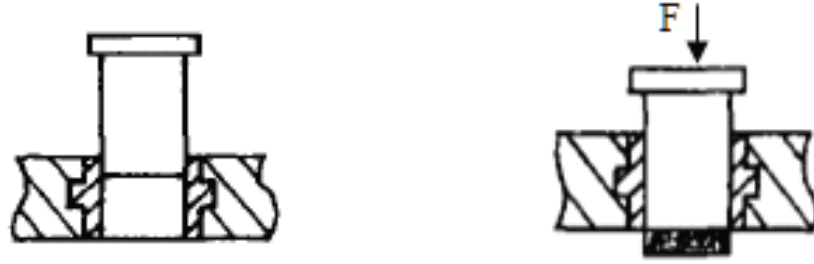
图 2-2 钢模制样示意图
