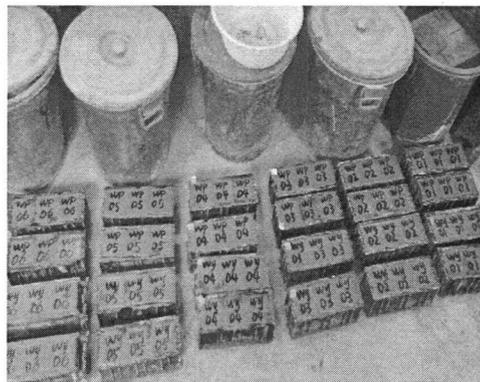
图 4-3 混凝土立方体试块成型
