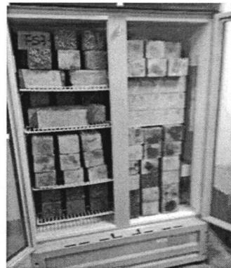
图 5-2 混凝土碳化箱与试件摆放
