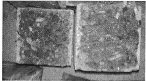
图 5-9 混凝土碳化深度 (28d)
