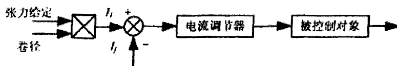
图 2.4 电枢电流控制回路原理图
