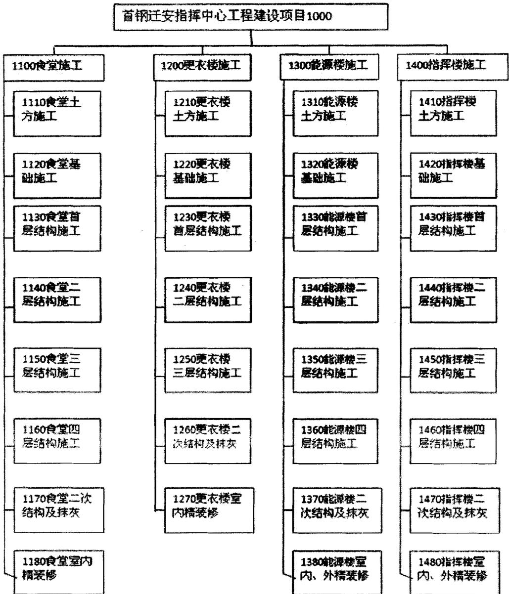
图 4.1 项目工作分解结构 (WBS)
