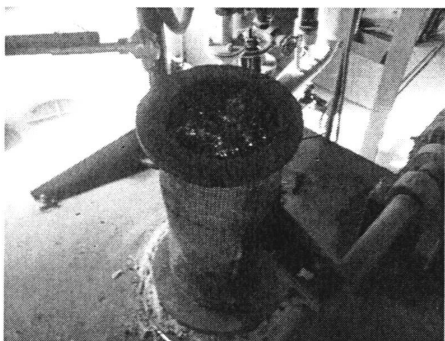
图 2.5 正在烧结中的烧结矿
