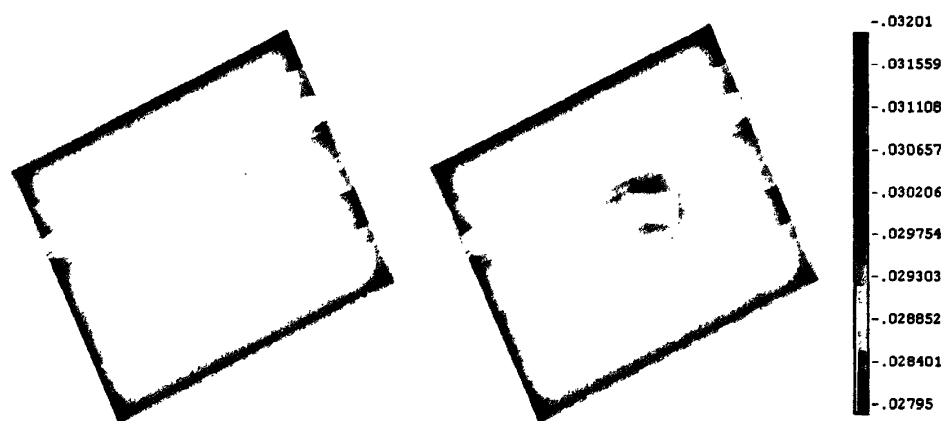
图 4.7 质量迁移对地面垂直位移场的影响
