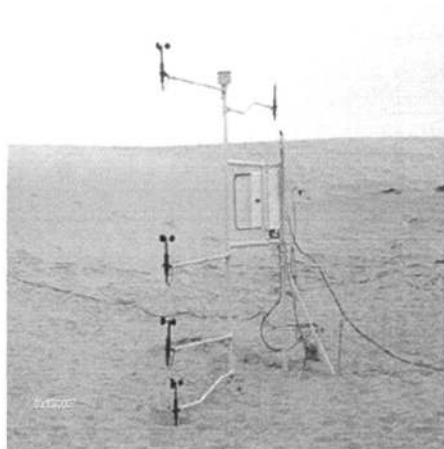
图2.3 轻质高频风杯式测速仪
