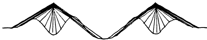
图 5-3 维修加固后二阶失稳模态 ( \lambda=19.21 )
