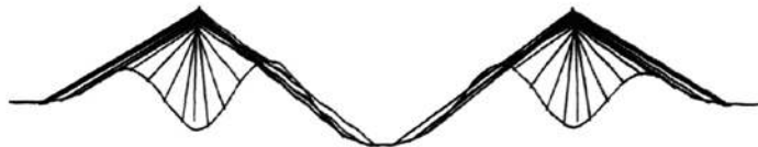
图 2-4 维修加固前二阶失稳模态 ( \lambda = 18.910 )
