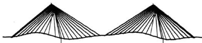
图 5-2 维修加固后一阶失稳模态 ( \lambda=7.55 )
