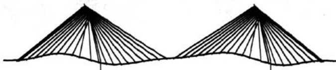
图 2-3 维修加固前一阶失稳模态 ( \lambda = 6.753 )
