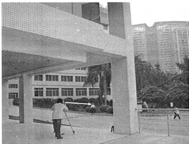
图 4-1 新技术系统在屋檐下自由设站进行地籍测绘
