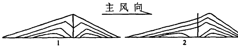
图 12 栅栏式方格沙障内积沙示意图
