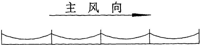
图 8 集束式方格沙障凹曲面 Fig.8 Concave of bundle cotton haulm
