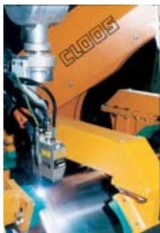
图 1-4 Meta 公司的焊缝跟踪传感器
