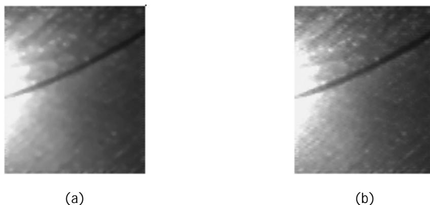
图 3-6 中值滤波前后图像对比 (a)滤波前 (b)滤波后
