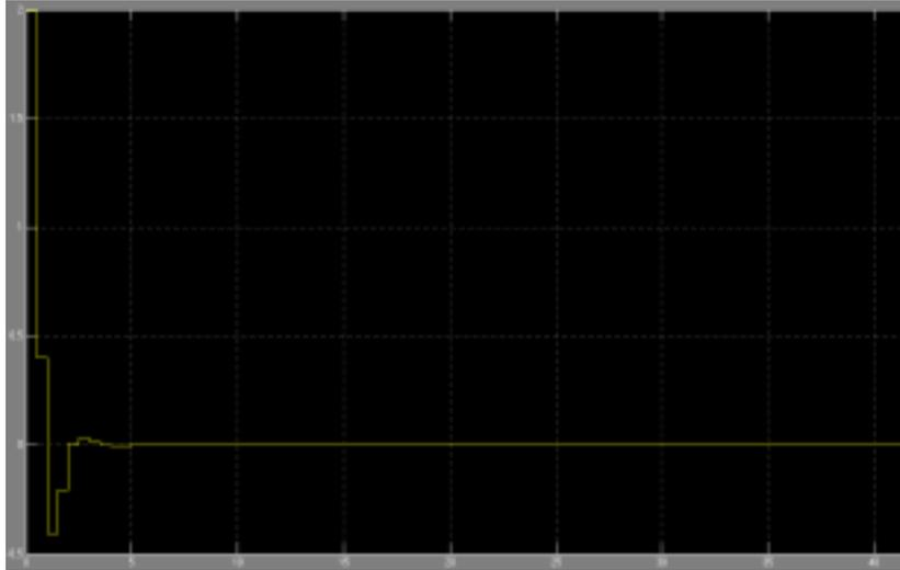
图 4-7 偏差量较大时 PID 参数的响应函数
