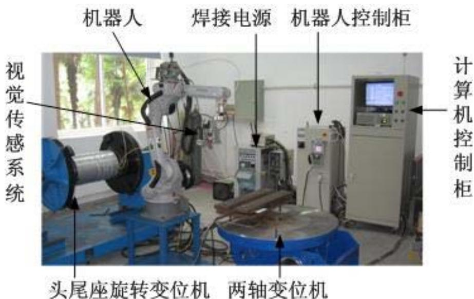
图 2-3 机器人焊接硬件系统实物图
