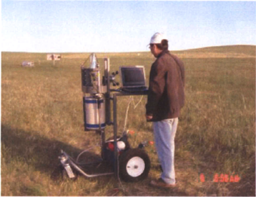
图 2-4 点源 ^{152}\text{Eu} 能量刻度 Fig.2-4 Energy calibration using Eu-152
