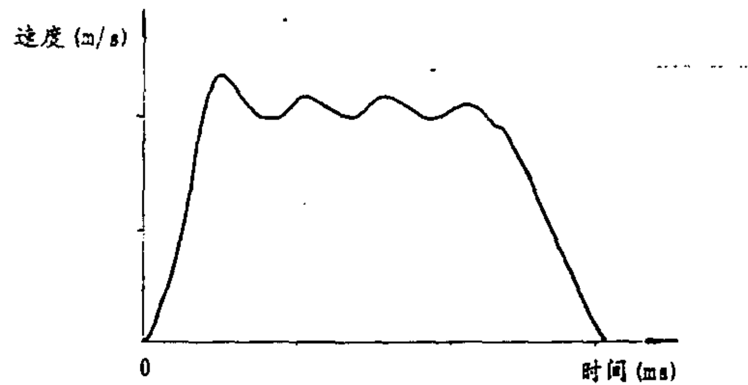
图4-15 剪刀实际运动速度示意图
