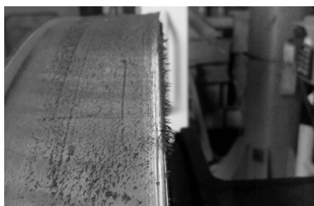
图4 圆盘剪剪刀磁化吸附的氧化铁皮碎屑
