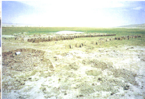
泡子里的土被取来脱坯盖房,晾干后的土坯表面会有白花花碱面
