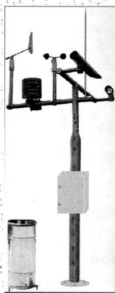
AMW 环境气象监测站的设计外观达到高速公路外场机电设备的要求。支架高度3m，各类传感器的布局合理，整体上给驾乘人员以视觉上的美感。所有布线都从支架钢管内穿越，进入机箱的线缆从机箱背面进入，以实现屏蔽保护和防止人为破坏的目的。支架各部件的连接采用避免从外面使用普通工具即可拆卸的连接方式，安装在地面上的雨量传感器，也采用外套件的方法将雨量传感器下部的所有连接部件罩住并配有防盗固定装置。
