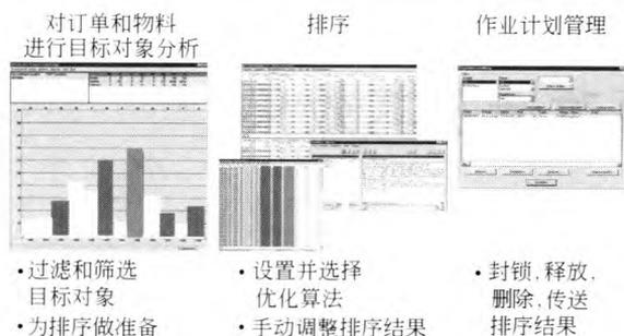
图3 PSI/ALS产线排序步骤示意图
