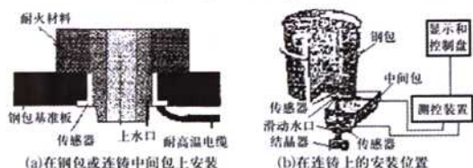
图3 电磁感应式示渣传感器在连铸机上安装图
