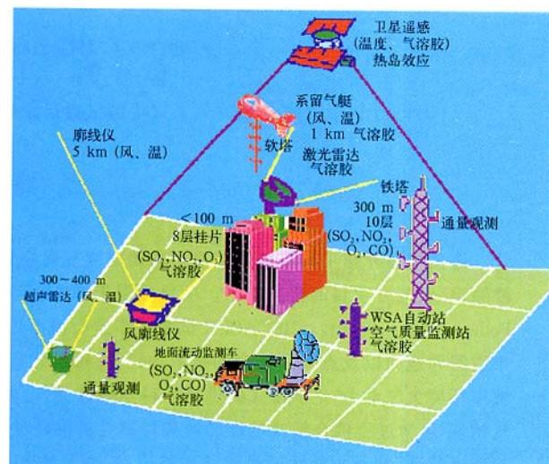
图 1 项目三维立体大气环境综合观测系统示意图
