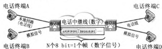
图 1 E1 中继线传输多路电话信号示意
