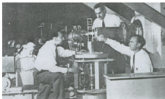
图10 Hofstadter设计的200 W的磁谱仪，与研究助手Lance Rogers、项目工程师F. W. Bunker测量质子的直径
