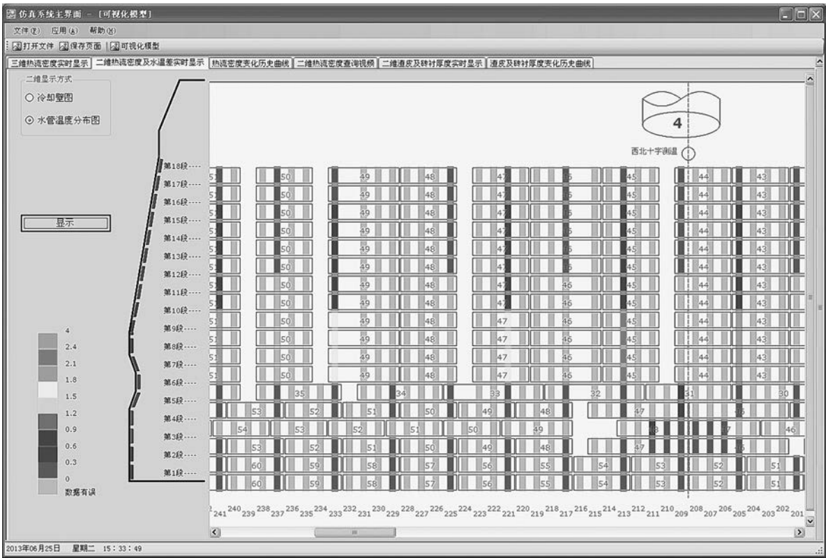
图 2 冷却壁水管水温差分布
