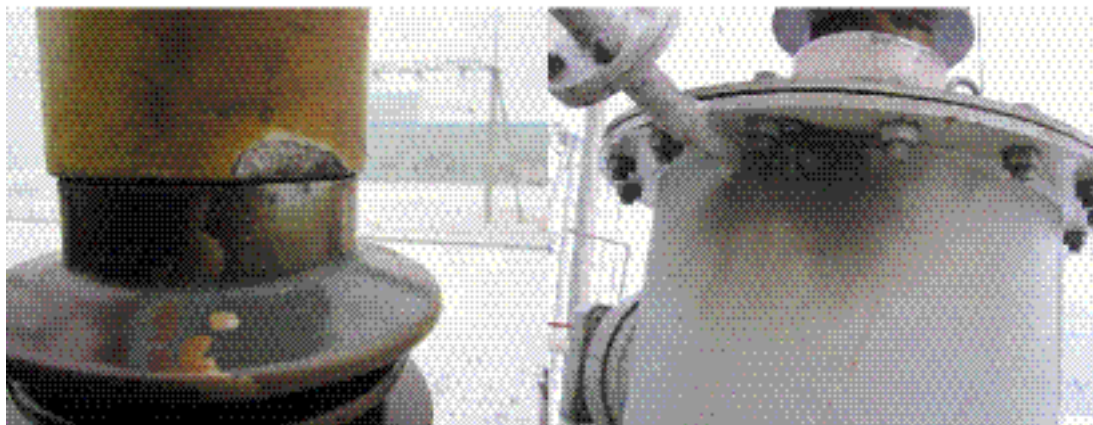
图1 变压器高压套管闪络故障点
