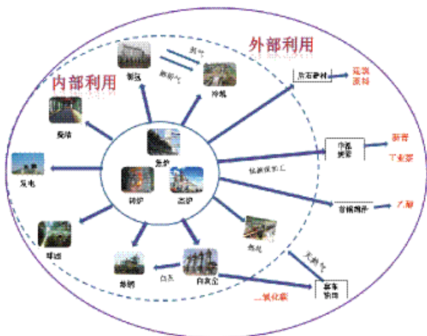
图2 煤气循环利用图
