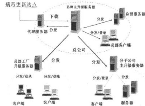
图1 分级管理、多重防护的防病毒管理架构
