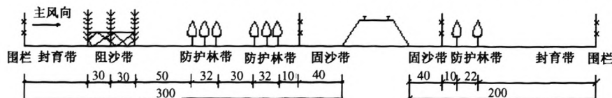
图 3 临策线沙害治理防护体系示意图
