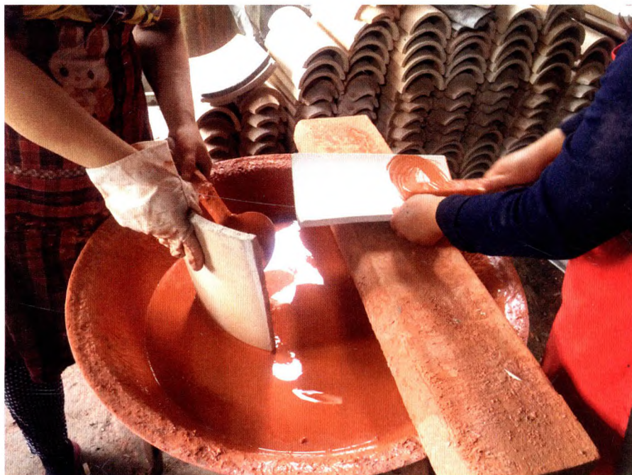
工人正在进行琉璃制作的施釉工序 李川/摄
