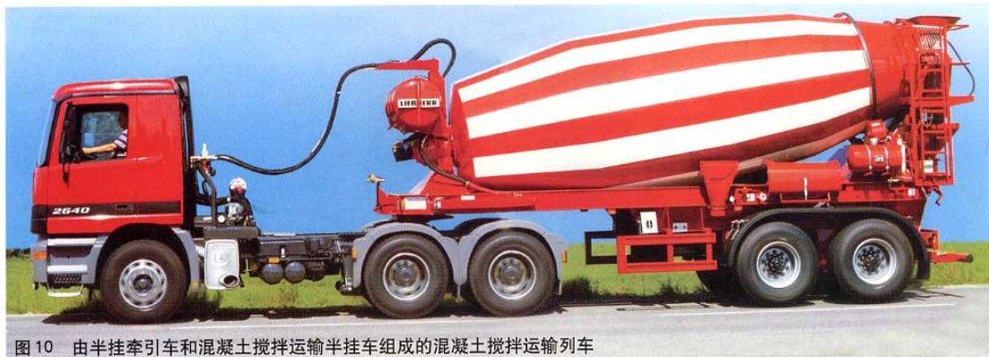
图10 由半挂牵引车和混凝土搅拌运输半挂车组成的混凝土搅拌运输列车
