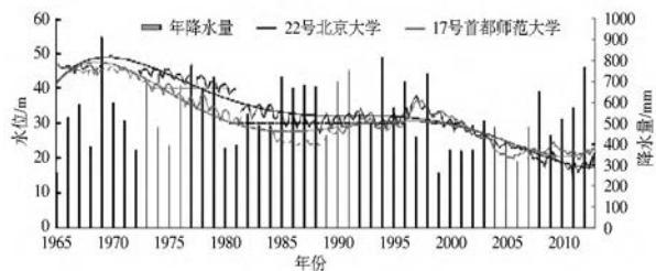
图 5 北京永定河流域观测孔地下水位动态曲线
