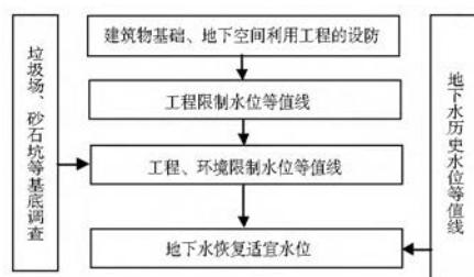
图2 地下水恢复适宜水位工作流程
