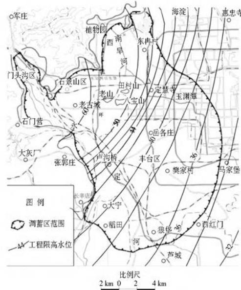
图3 工程限制水位等值线
