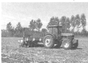
图 1 1750 型精量免耕播种机播种作业情况及出苗长势
