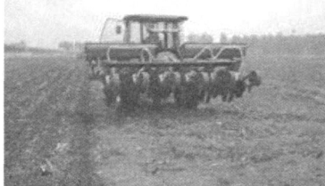
图 3 2BQM-6D 型气吸免耕播种机播种作业情况及出苗长势
