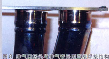
图8 排气口接头与排气管采用直接焊接结构
