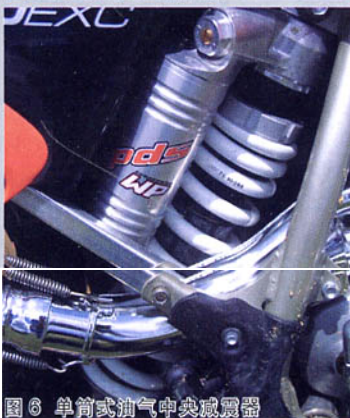
图6 单筒式油气中央减震器
