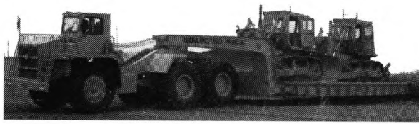
图 2 150 t 平板运输车现场图
