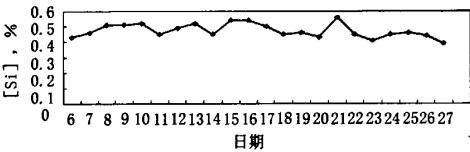
图2 首钢4号高炉铁水中的硅含量(2007年11月)
