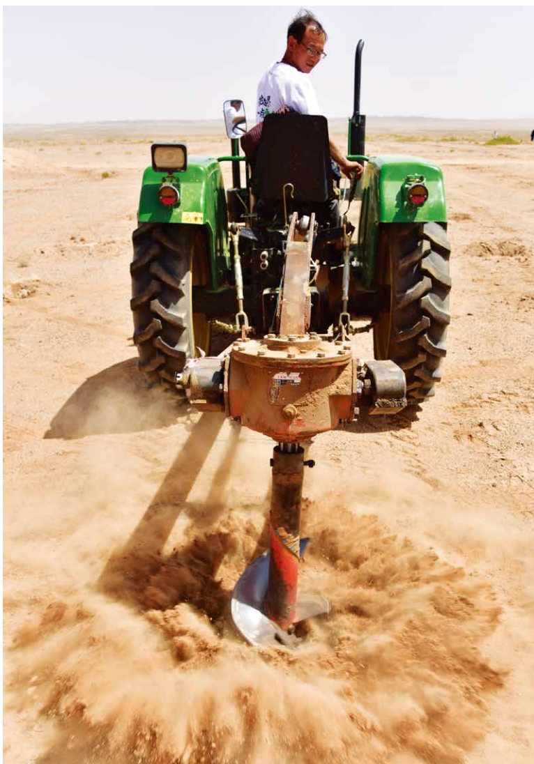
苏海图嘎查牧民沈永保开着专业挖坑机在为梭梭种植打坑
